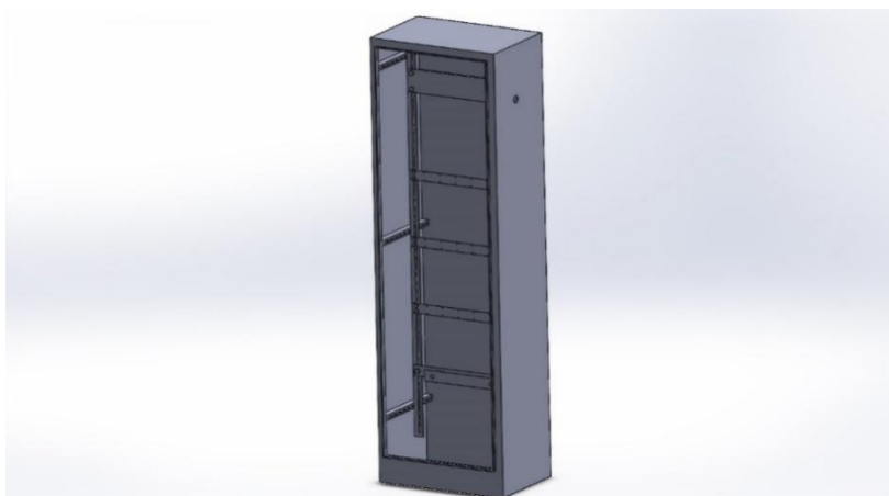
Рисунок 3 – Пустой силовой шкаф
